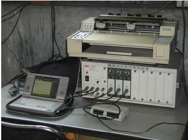
写真1. ガス圧測定装置
