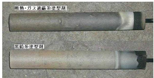
写真3. 浸漬後の塗膜状態(シェル)
